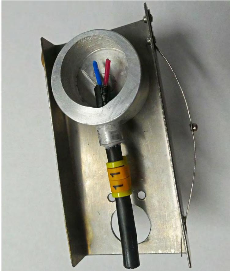
Esquema da capsula para a montagem do eletrônível
